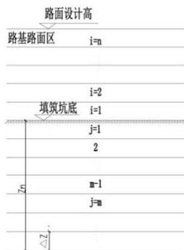
计算垃圾填筑引起坑底下原状土体沉降土柱分层示意图
